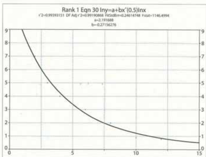
2. ábra. Acél lézer-vágási sebessége [mm/min] a lemezvastagság t [mm] függvényében
