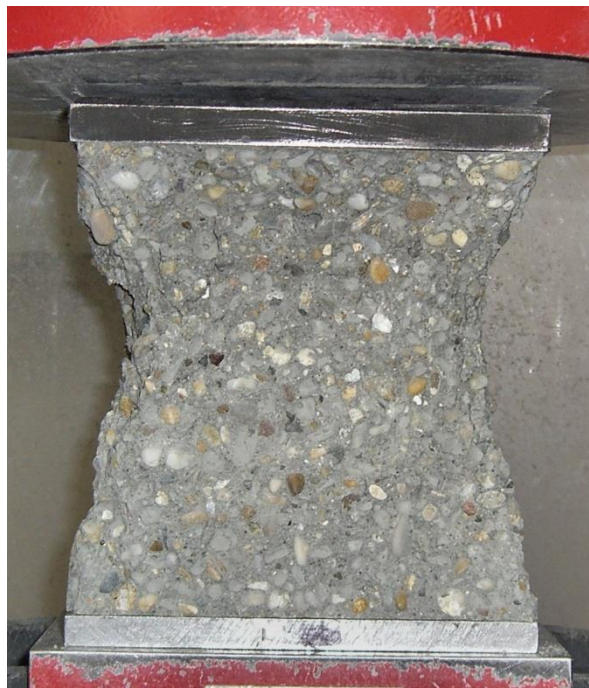
20.1.1.1. ábra: Próbakocka megfelelő, szabályos, szimmetrikus törésképpel
