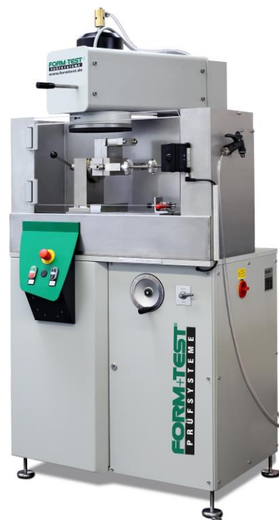
20.1.1.30. ábra: Példa napjaink gyémánttárcsás laboratóriumi betonpróbatesszológépére ( https://www.formtest.de )
