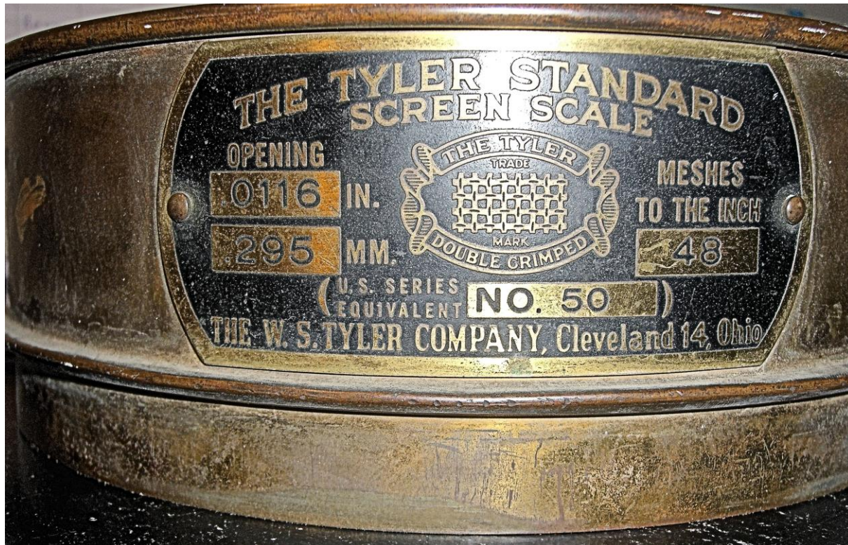
ábra: Eredeti 48 jelű, 0,0116 inh (0,295 mm) lyukbőségű Tyler-szita
