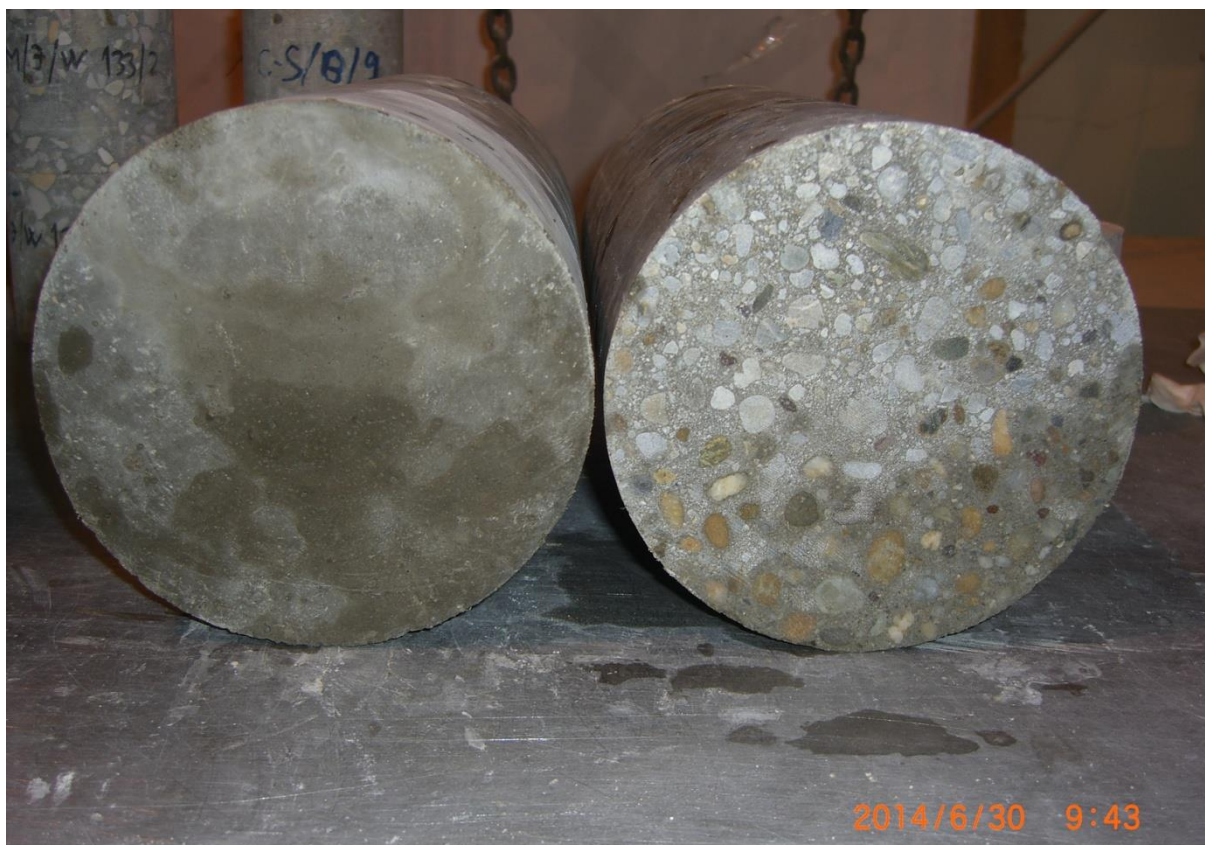
20.1.1.32. ábra: Formában készített, 28 napos korú, végig víz alatt tárolt, Ø150×300 mm
