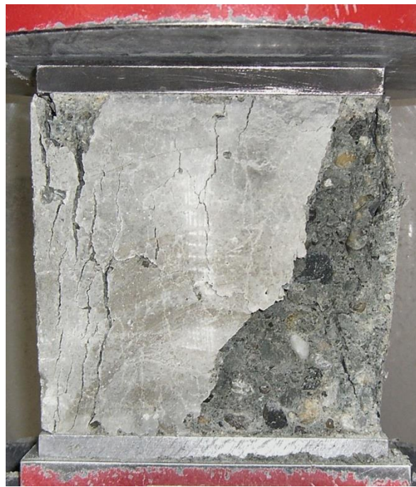
20.1.1.2. ábra: Próbakocka nem megfelelő, szabálytalan, aszimmetrikus törésképpel
