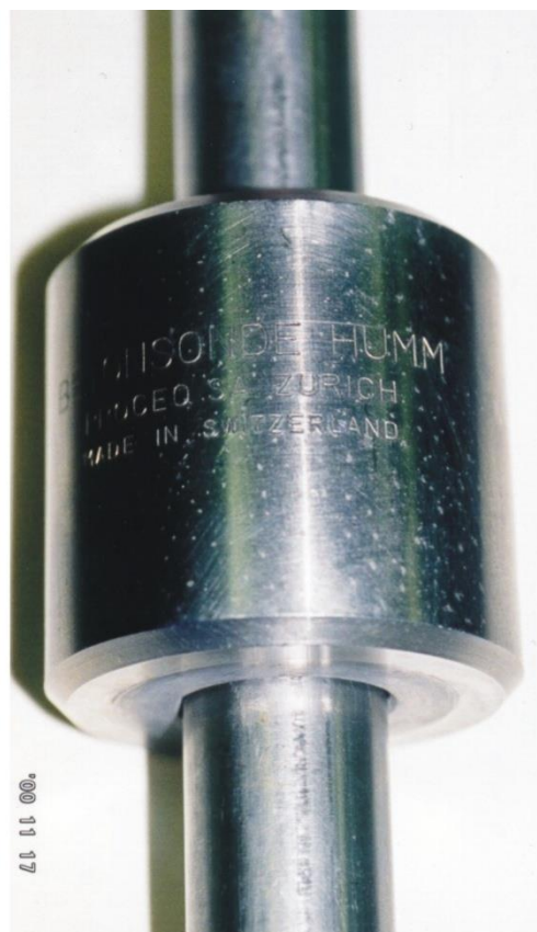
17.9. ábra: Graf -féle ejtősúlyos, behatolásmérő készülék (Palotás – Balázs 1980) 17.10. ábra: Humm -féle behatolási mélység mérő szonda
