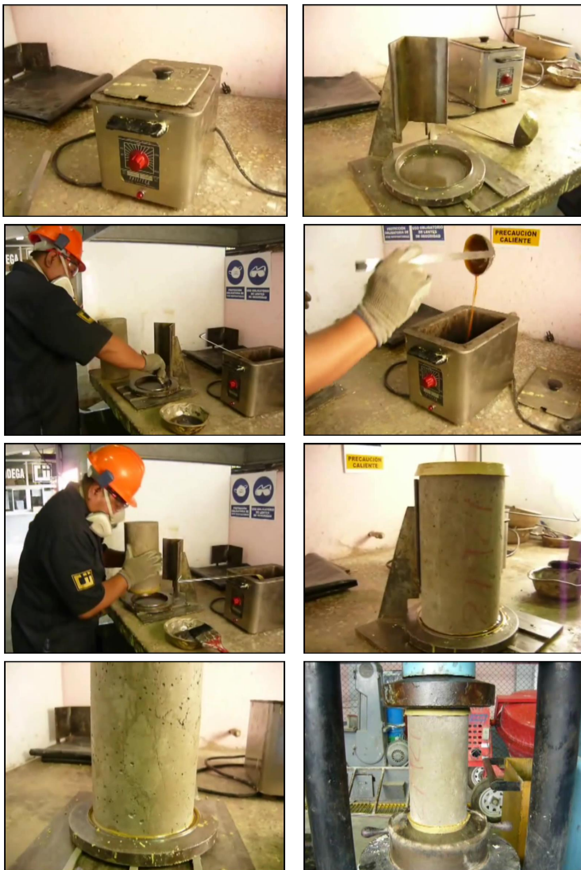
20.1.1.27. ábra: Próbahengerek nyomott felületének kénhabarcs sapkázása az ASTM C39/C39M:2018 szabvány szerint. (Centro de Investigacione de Ingeniera, Seccion de Agredados, Concretos y Morteros. Guatemala, 2011. https://www.youtube.com/watch?v=PqTzsN4nz-4 )
