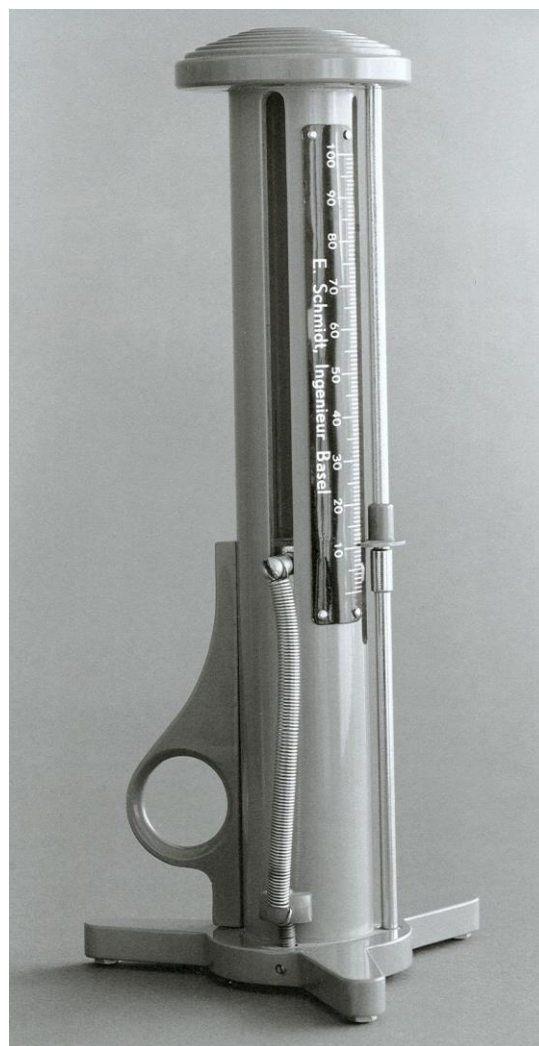
20.1.3.2. ábra: Az eredeti, háromlábú Schmidt-kalapács modellje az Ernst és Albert Schmidt munkásságát bemutató albumból (Schmidt, F. W. et al. 2014)
