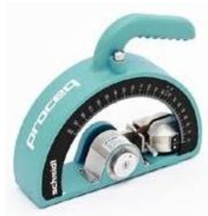
20.1.3.5. ábra: OS-120 típusú Schmidt -kalapács. Elődje a P -típusú Schmidt -kalapács ( https://www.pasisrl.it )
