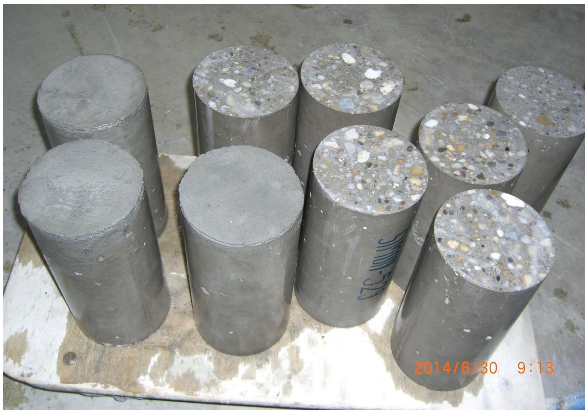
20.1.1.31. ábra: Formában készített, 28 napos korú, végig víz alatt tárolt, Ø150×300 mm méretű, cementhabarccsal simított és csiszolt felső nyomott felületű nyomószilárdság vizsgálati próbahengerek ( Kausay – Simon 2017 )
