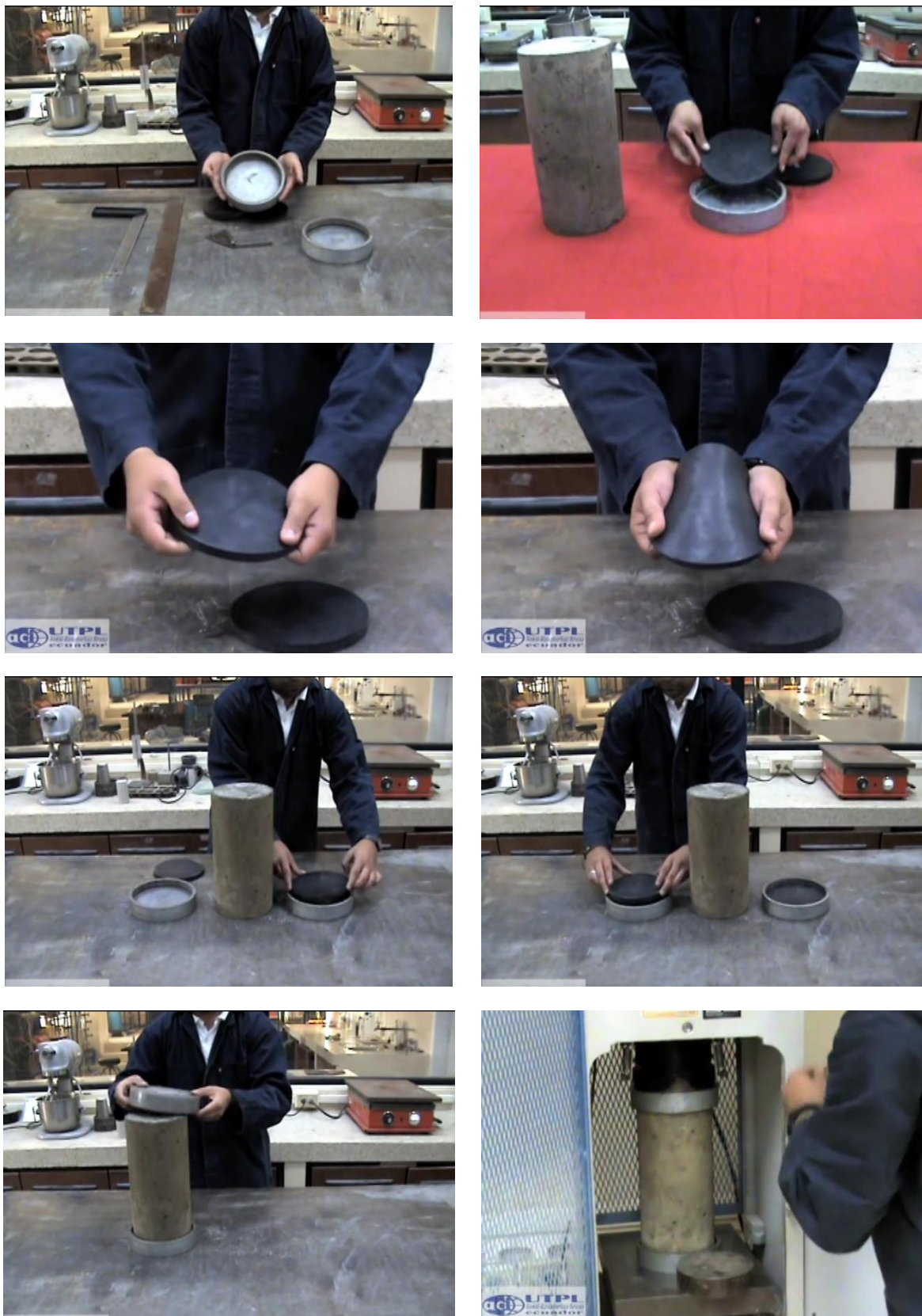
20.1.1.28. ábra: Próbahengerek nyomott felületének neoprén alátetes elasztomer-papucsozása az ASTM C1231/C1231M:2015 szabvány szerint. (Universidad Técnica Particular de Loja. Tecnico an Laboratorio de Concrete. Ecuador, 2015. https://www.youtube.com/watch?v=Wz5zJjQuFkM )
