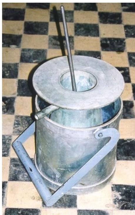
17.8. ábra: Ma már nem szabványos ejtőkengyeles készülék az átformálási ütésszám mérésére
