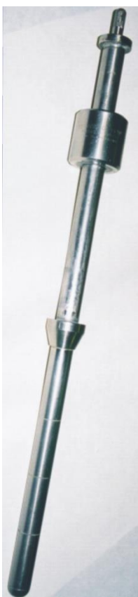
17.9. ábra: Graf -féle ejtősúlyos, behatolásmérő készülék (Palotás – Balázs 1980) 17.10. ábra: Humm -féle behatolási mélység mérő szonda
