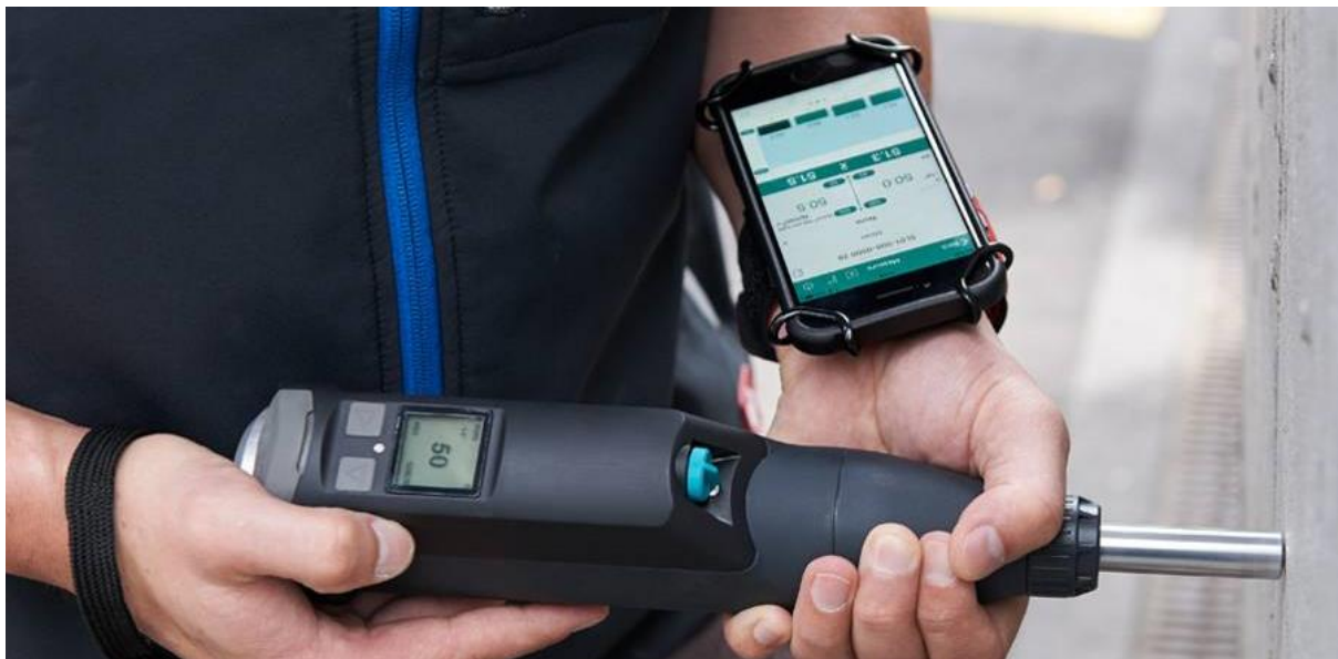
20.1.3.7. ábra: Original Schmidt Live típusú Schmidt -kalapács ( https://www.proceq.com/product/original-schmidt-live )
