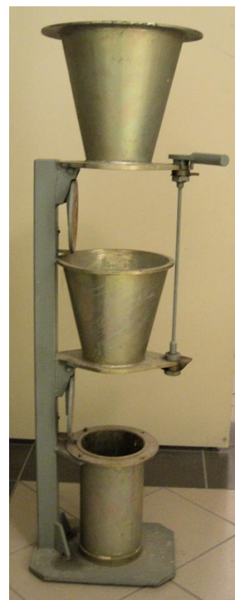
17.6. ábra: Glanville-féle készülék a tömörödési tényező mérése
