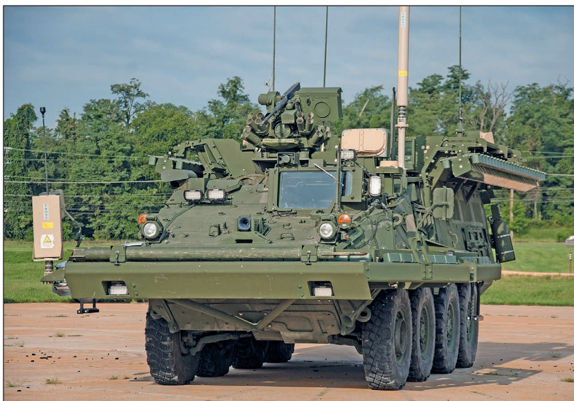
22. ábra. Az elvetett Iron Curtain reaktív páncélzat (DoD)
