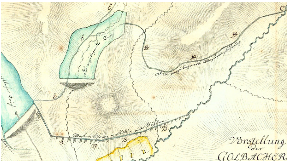
149. Egy tervezett, egy meglévő és egy elbontani javasolt vízvezető a kolpachi új tó 1738-ban készített tervén (SBA, részlet)
