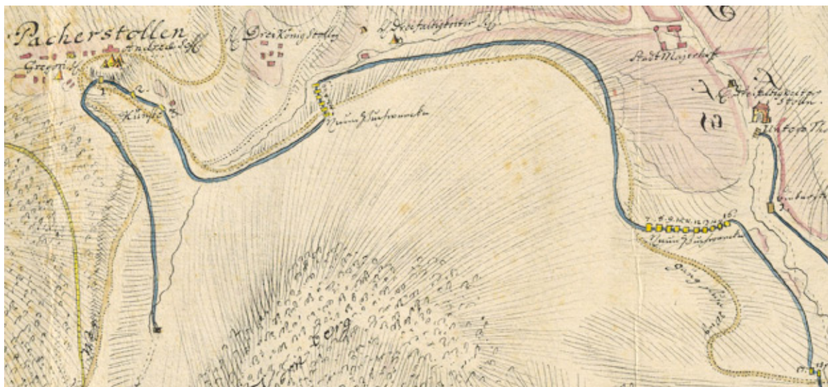
147. 18 új zúzómű a vízhasznosítási koncepcióterven, a vízvezető árok Selmecbánya melletti szakaszán (SBA, részlet)
