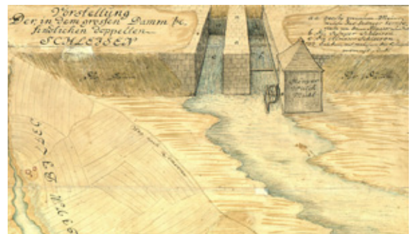
179. A terv mellékábrája: a kettős átfolyó a római töltésen a kallómalommal (MNL OL részlet)
