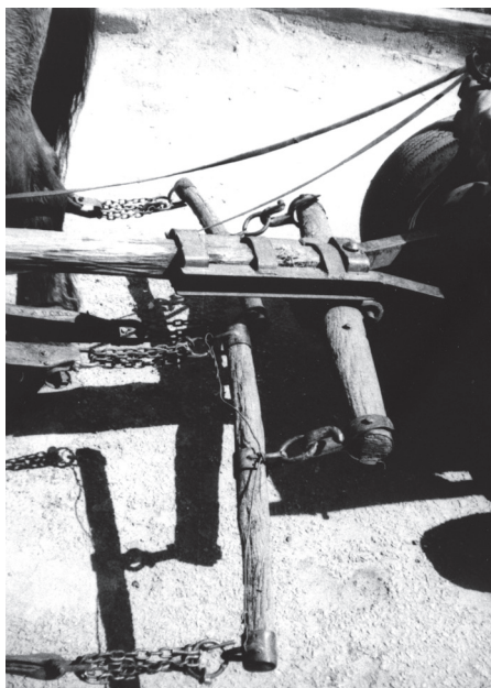
49. kép. Hámfák kapcsolása a vóghoz. Debrőd. Paládi-Kovács A. felv. 1994.
