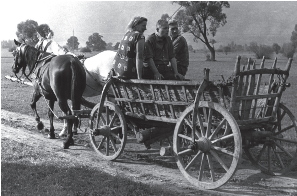
52. kép. Lőcsös lovas szekér vóggal, oldalkassal, kerékfűkező dörzsölő fával. Bódvalenke. Paládi-Kovács A. felv. 1969. NKI F 879
