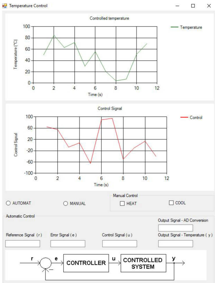
3.5. ábra. A hőmérséklet-szabályozást megvalósító program felhasználói interfésze
