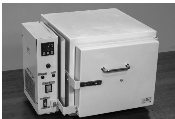
7.5. ábra. Kemence önhangoló szabályozás tesztelésére
