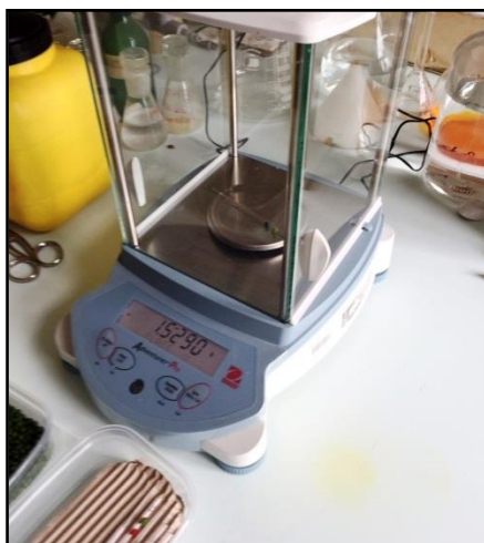
1. ábra. Az üveg kapillárisok nettó tömegének mérése.
