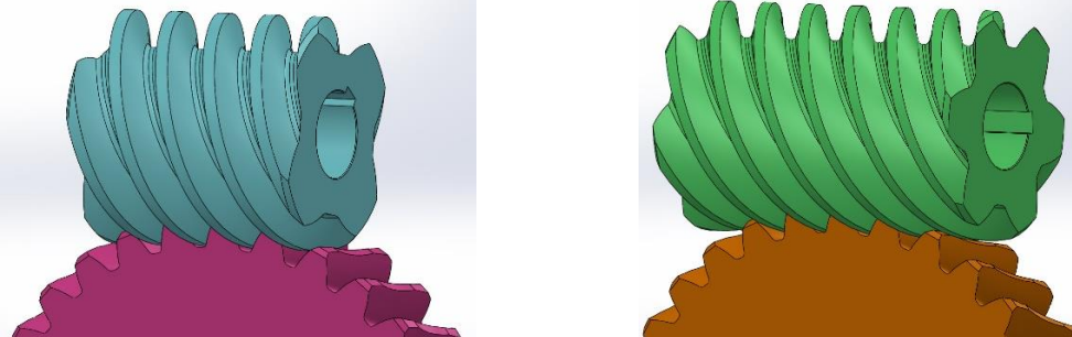
b) m_{ax}=5 \text{ mm} , z_1=4 , z_2=30 , \alpha_0=20^\circ , \Sigma=90^\circ , right hand c) m_{ax}=5 \text{ mm} , z_1=6 , z_2=30 , \alpha_0=20^\circ , \Sigma=90^\circ , right hand
