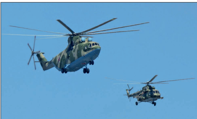
101. ábra. A Mi-8 AMTS többcélú harci szállítóhelikopter külső üzemanyagtartályokkal és az óriási Mi-26 szállítóhelikopter. A kép jól szemlélteti a két helikopter közötti méretkülönbséget
