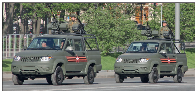
90. ábra. Az UAZ-3163 Patriot pickup könnyű személyszállító gépjárművek bukócsőveire fegyverzetként 12,7 mm-es 6P57 Kord nehéz géppuskát és a 7,62 mm-es 6P41 PKP géppuskát szereltek fel
