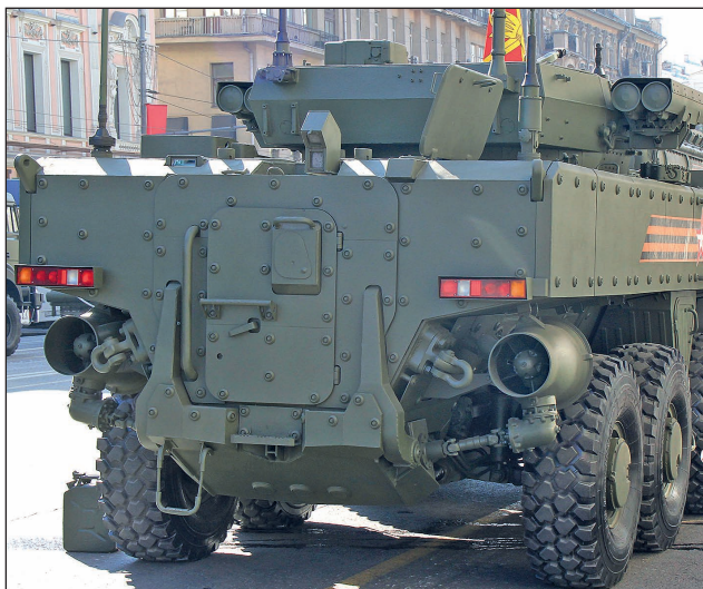
96. ábra. VPK-7829 K-17 Bumerang kerekes gyalogsági harcjármű hátulról. A képen megfigyelhető a hátsó ajtó, az ajtó feletti kamerás megfigyelőrendszer, valamint a kétoldali vízsugar-hajtómű
