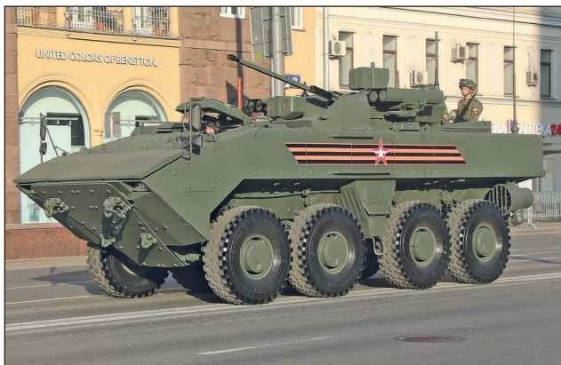
95. ábra. VPK-7829 K-17 Bumerang kerekes gyalogsági harcjármű. A motor és az áttételi művek a vezetőtől jobbra találhatók. A képen látszik a gépágyúfegyverzettel párhuzamosított 7,62 mm-es 6P7K PKTM géppuska, és a két célzóberendezés (bal oldali nézet)
