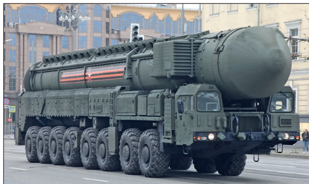
89. ábra. Az 15P155M, RSz-24 Jarsz önjáró interkontinentális ballisztikus rakétakomplexum, jobb oldali nézetben
