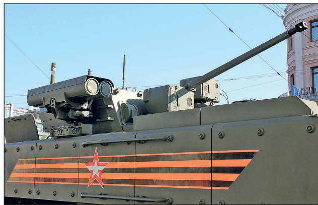
97. ábra. A VPK-7829 K-17 kerekes gyalogsági harcjármű Bumerang-BM tornya, közepén a 30 mm-es 2A42 gépágyúval, oldalán a Kornet-EM páncéltörő rakétákkal
