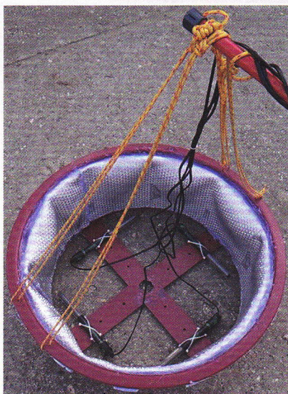
Vízbe meríthető fűtőegység. Az alján lévő rések teszik lehetővé az ebihalak számára, hogy alulról beússzanak az akváriumfűtők által felmelegített vízterbe, amelyet a szigetelt oldalfalak tartanak egybe. Az oldalfalak felső külső pereme mentén elhelyezett úszók tartják a fűtőegységet a vízfelszínen.
