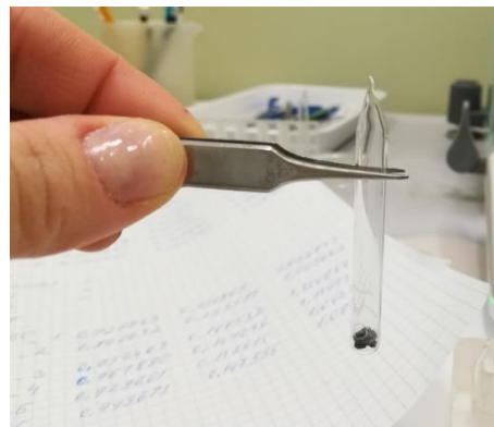
(30. Ábra) A légmentesen lezárt kvarcüveg cső, benne a mintával.
