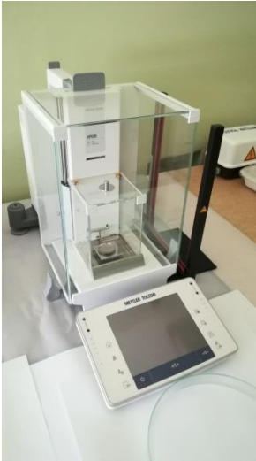
(27. Ábra) Mettler Toledo mikromérleg
