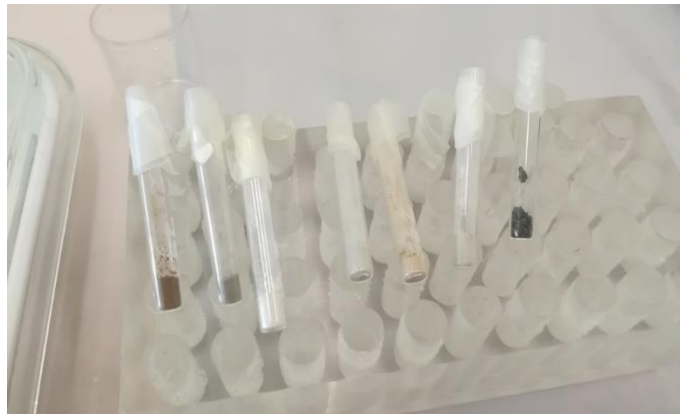
(28. Ábra) A parafilmmel lezárt kvarccsövek, bennük a mintákkal.
