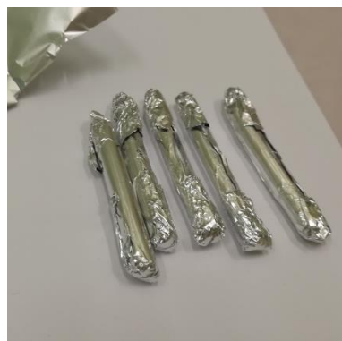
(33. Ábra) Alumíniumba csomagolt kvarccsövek
