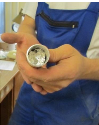
(36. Ábra ) Az alumínium tokba helyezett mintaköteg
