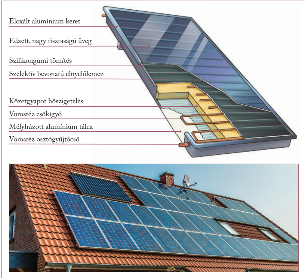
6.23. ábra. Síkkollektorok felépítése és felszerelési módja
