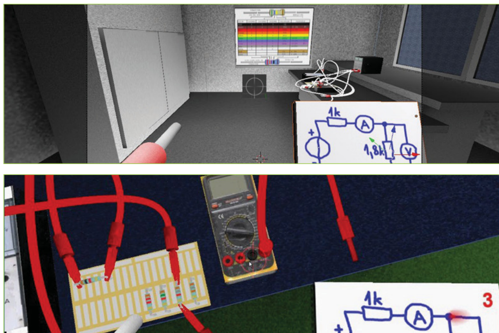
2.12. ábra. Virtuális mérés: voltmérő bekötése programmal
