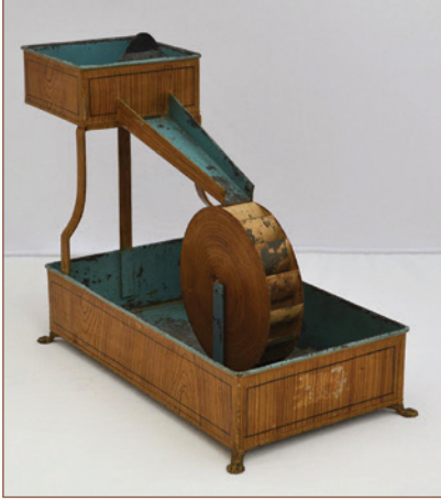
4.8. ábra. Felüksapó vízikerek dinamikus modellje a 19. század végétől
