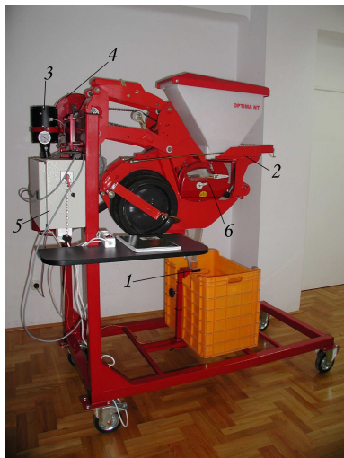
4.ábra. Vetési pontosság vizsgáló készülék
