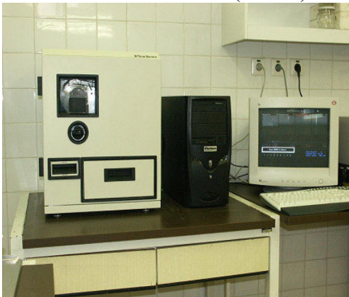
2. ábra Az SKCS 4100 mérőműszer és mérési elve (Szabó, 2009)
