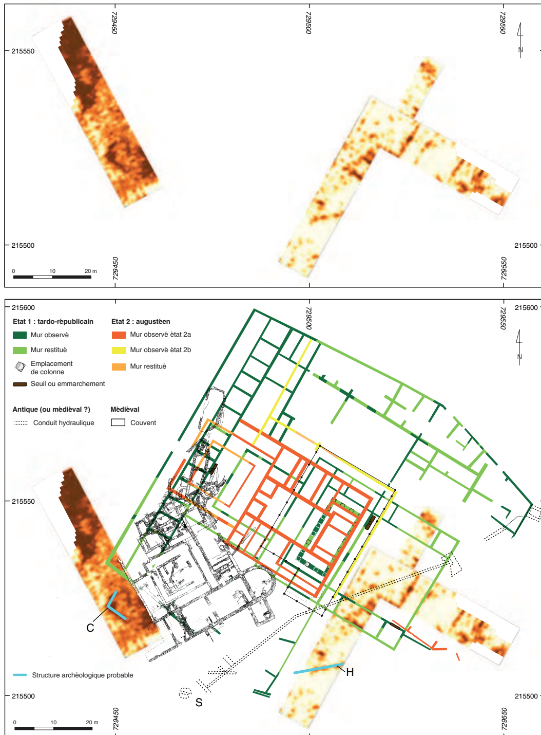
4. Bibracte, Mont Beuvray. Prospections géophysiques à la Pâtûre du Couvent et au Champlain. La Pâtûre du Couvent. Résultat des prospections au géoradar de 2013, avec constante de temps de 45 ns.
