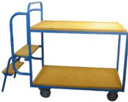
5.3.4. ábra: Kommissiózó kézikocsi létrával Kézi kommissiózáskor a kommissiózó dol-
