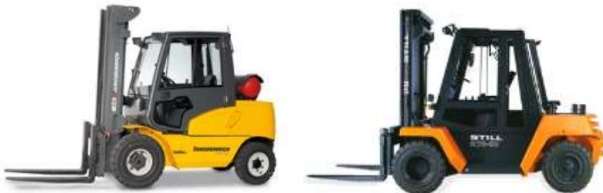
3.5.7. ábra: Korszerű normál emelésű villástargoncák a) elektromos, b) Diesel-motoros
