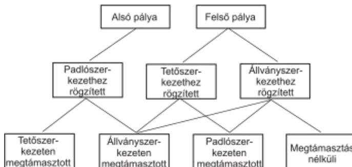
3.6.1. ábra: A pályaelhelyezés és a megtámasztás lehetséges kombinációi
