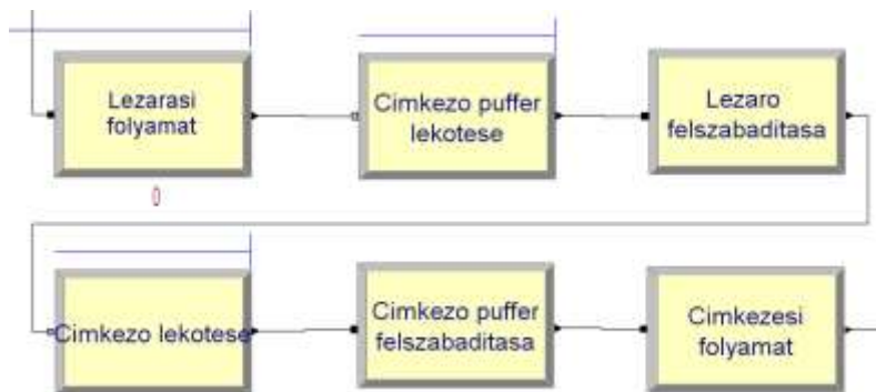
5.24. ábra: A blokkolás alternatív modellezése Resource modulokkal
