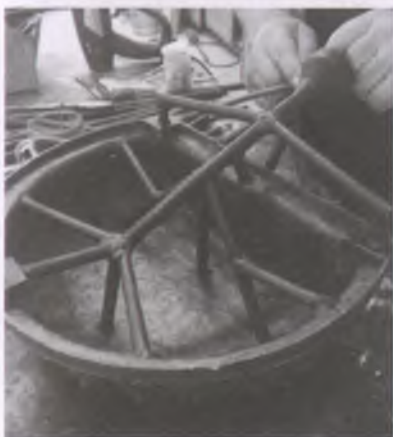
15. fotó A viaszminta csatornázása öntéshez
