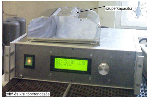
7. ábra. Szuperkapacitásra alapozott nagyáram impulzust előállító berendezés.
