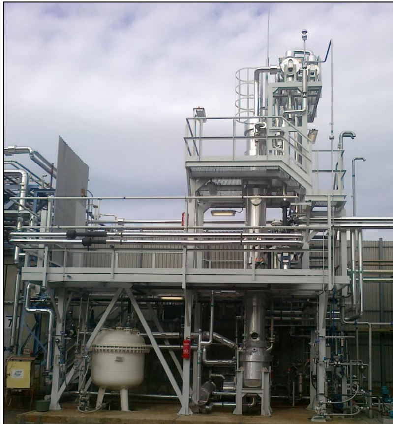
Diklór-metánt eltávolító oszlop a kutatócsoport eredményei és technológiai tervei alapján (2012)
