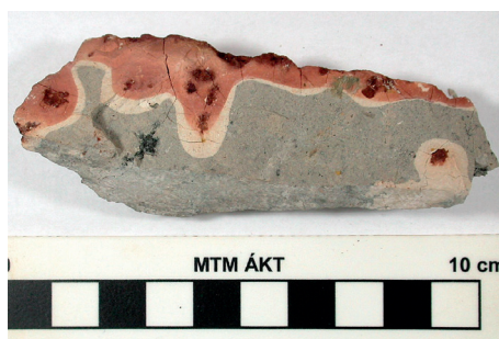
15. ábra. Szürke és vörös bauxit érintkezése, Darvastó IV. bányaterület, 140-es szint, Nyirád, Veszprém megye. HNHM MRM B.1332.
