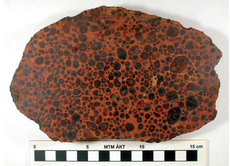
17. ábra. Pizolitos bauxit, Mjacskovo, Komi Köztársaság, Oroszország. Georgij Ivanovics Busingin gyűjtése, 1956. HNHM MRM B.1009.
