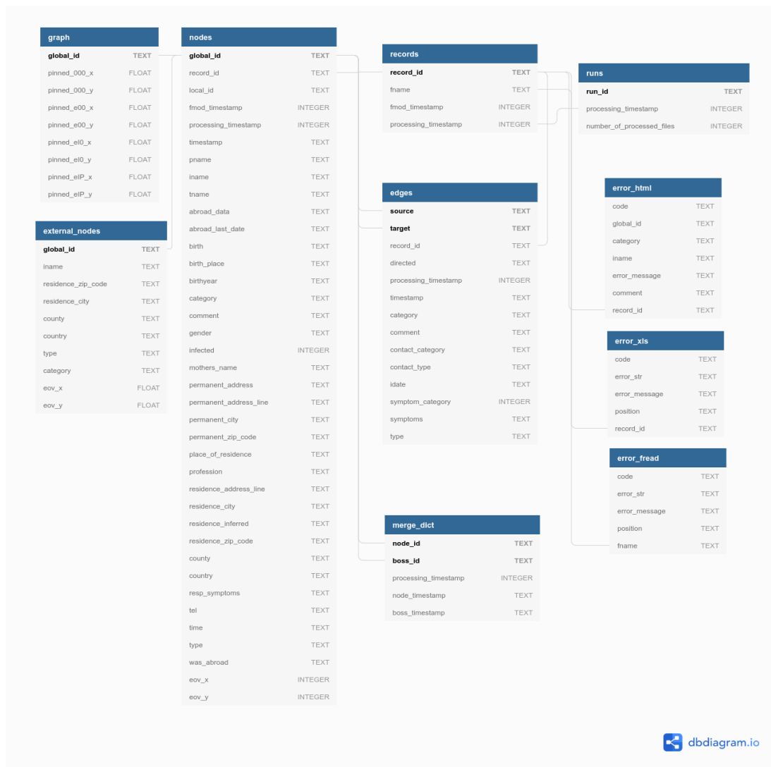
2. ábra | Az SQLite adatbázis sémadiagramja. Kék alapon a táblanevek, alatta a mezők nevei és adattípusai, félkörrel az elsődleges kulcsok vannak kiemelve. A kapcsolható mezők között futnak az élek
