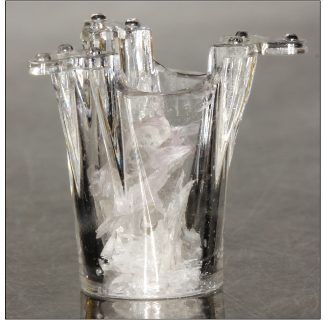
4. kép: Millicell inzerbe helyezett MED610-ból nyomtatott összetört henger
