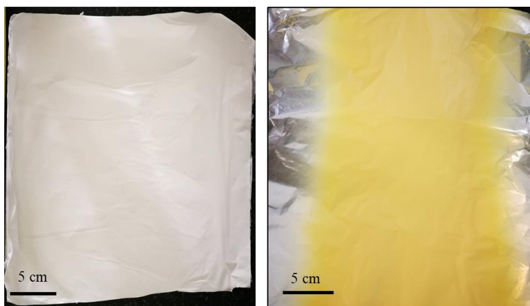
5. ábra: Elektrosztatikus szálképzéssel előállított PSI szálak rendszer, illetve ezüst nanorészecskék jelenlétében mutatott sárgás elszíneződése.
