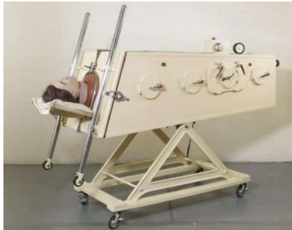
5. ábra A Both-féle fából készült „vastüdő” 39
