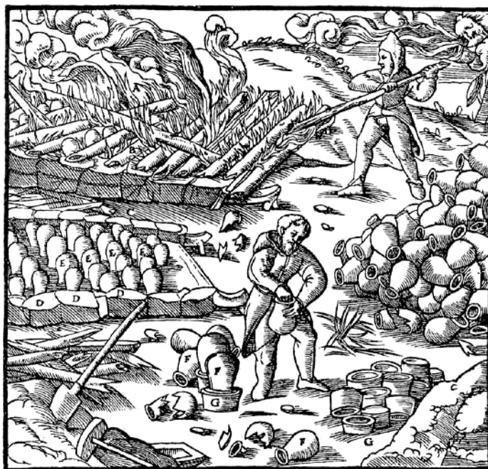
A – égő olvasztótűzhely; B – fahasábok; C – még nem égő tűzhely, amelybe berakják az edényeket; E – az edények sora; F – felső edények; G – alsó edények
