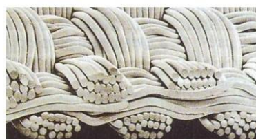
78 dtexes filamentfonalak, 23 db filamentág, 3,4 dtex/filament
