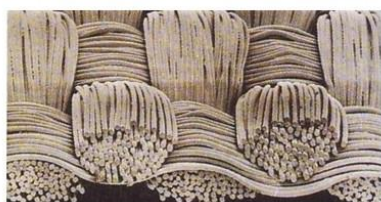
78 dtexes filamentfonalak, 98 db filamentág, 0,8 dtex/filament
