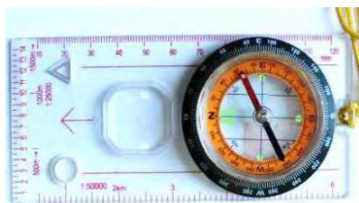
26. ábra. Tájéolóval kiegészített iránytű
