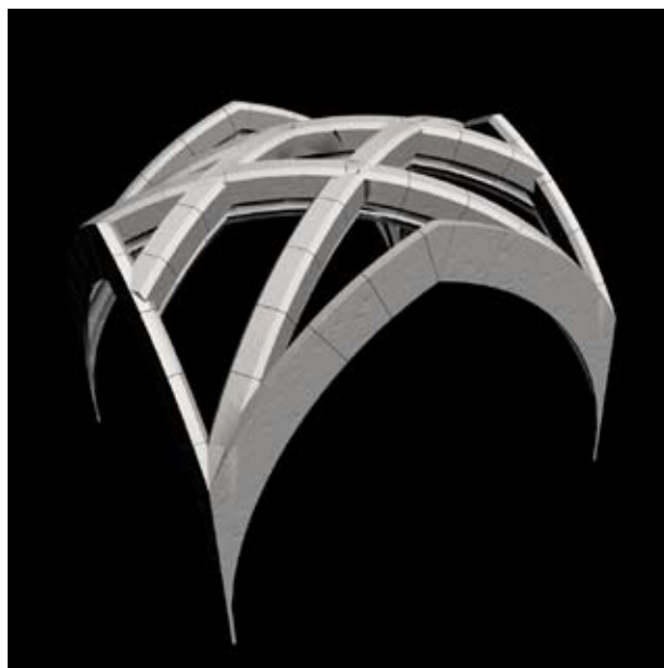
9. A templom toronyaljának rekonstruált boltozata, a bordaváz felülnézete
