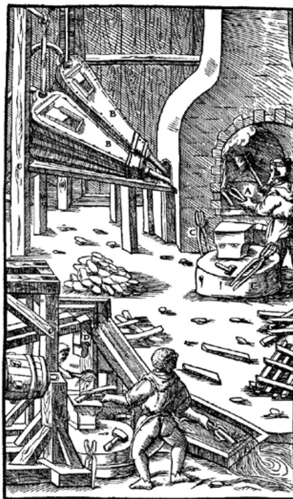
Das Frischfeuer A. Die Blasebälge B. Die Zangen C. Der Hammer D. Das stoßende Waffel E.
