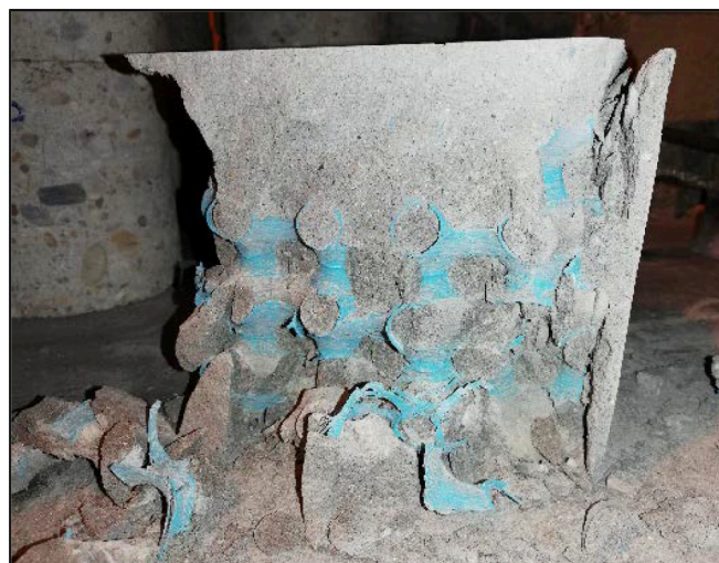
23. ábra: Térráccsal erősített próbakocka törésképe
