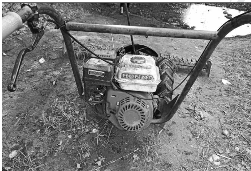
4. kép. Kaszálógép felújítva, Honda-motorral (ifj. Oláh Sándor felvétele)
