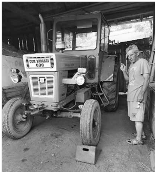
6. kép. Egy volt traktorista, a vadadi Kovács Károly az egykori munkahelyén, a nyárádszeredai Mezőgazdasági Gépállomás nyárádszentmártoni részlegén használt, majd 2000-ben onnan megvásárolt, 1981-ben gyártott U 650-es traktorral. Jól látszik a bal első kerék támasza: a csűr lejtős talajú, ha nem indul több próbálkozás után sem a motor, akkor meg lehet próbálni gurulás közben beindítani.
