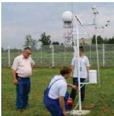
1. ábra. Automata meteorológiai mérőállomás ellenőrzése
