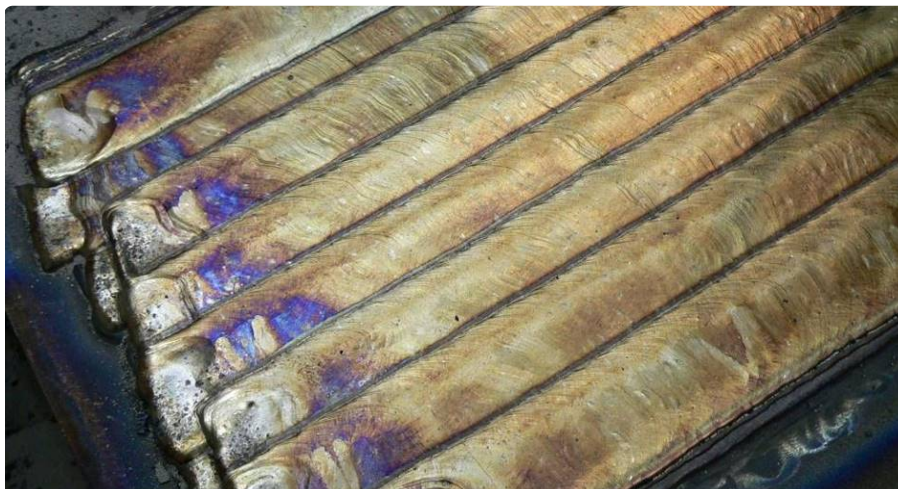
6. ábra. Szalagelektrodás fedett ívű hegesztéssel szénacélra felhegesztett, korrózióálló réteg
