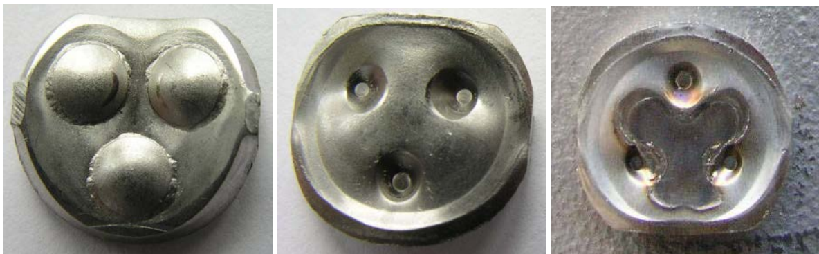
28. ábra. Mesterségesen kialakított dudorok egy bűvárszivattyú-alkatrészen
