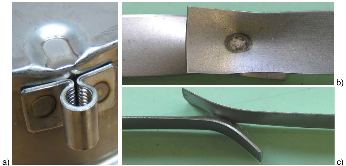
22. ábra. Ponthegesztett fül búvárszivattyú-motorházfedélen (a), lemezek ellenállásponthegesztett átlapolt kötéseinek alakváltozása a nyíróvizsgálat során (b, c)
