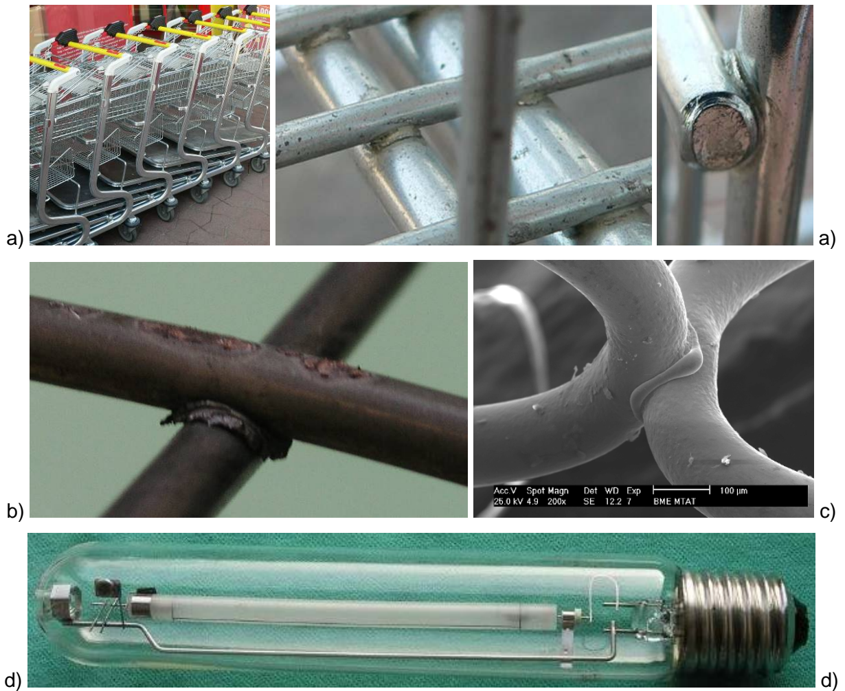
27. ábra. A dudorhegesztés alkalmazási példái; a) bevásárlókocsi, b) betonacélhuzal, c) értágítóbetét egy varrata, d) üvegházi világításra alkalmazott, nátriumgőz kisülőlámpa
