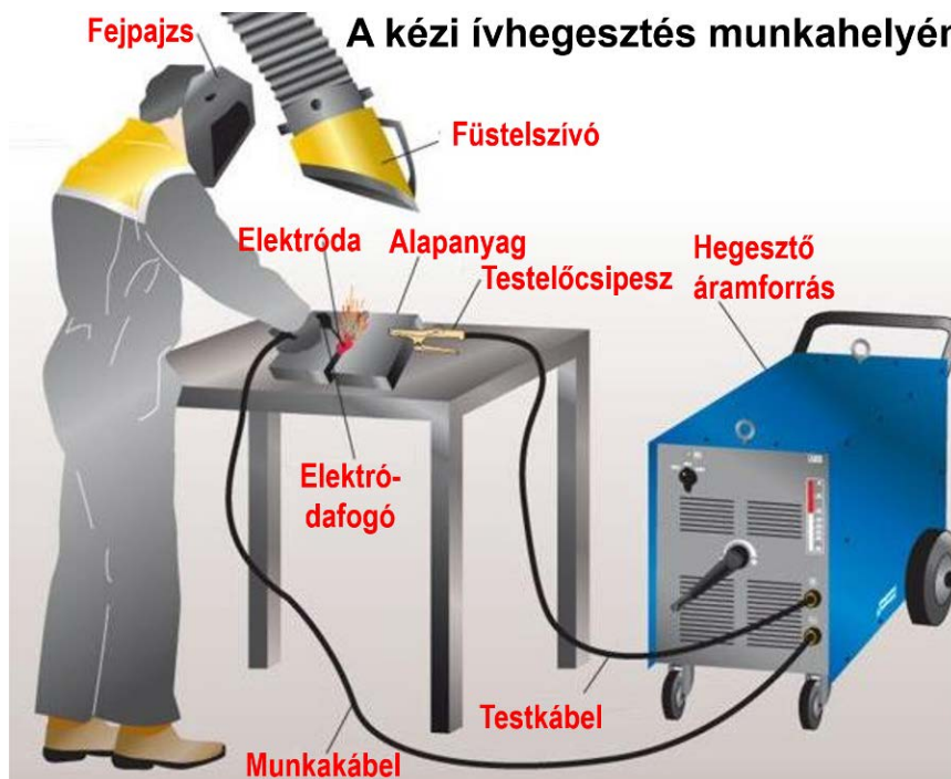
12. ábra. A kézi ívhegesztési munkahely felszerelése
