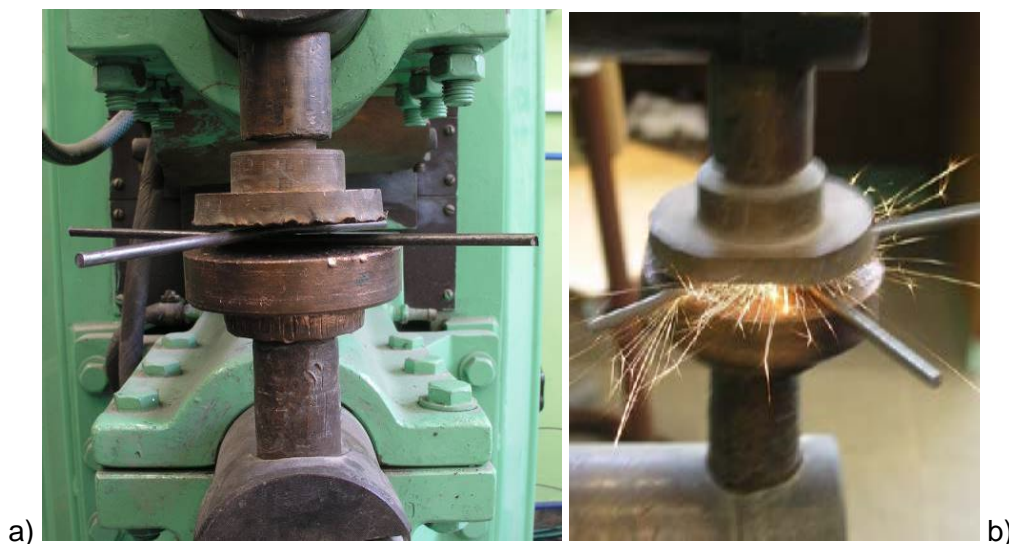
26. ábra. Keresztbe fektetett huzalok ellenállás-dudorhegesztése
