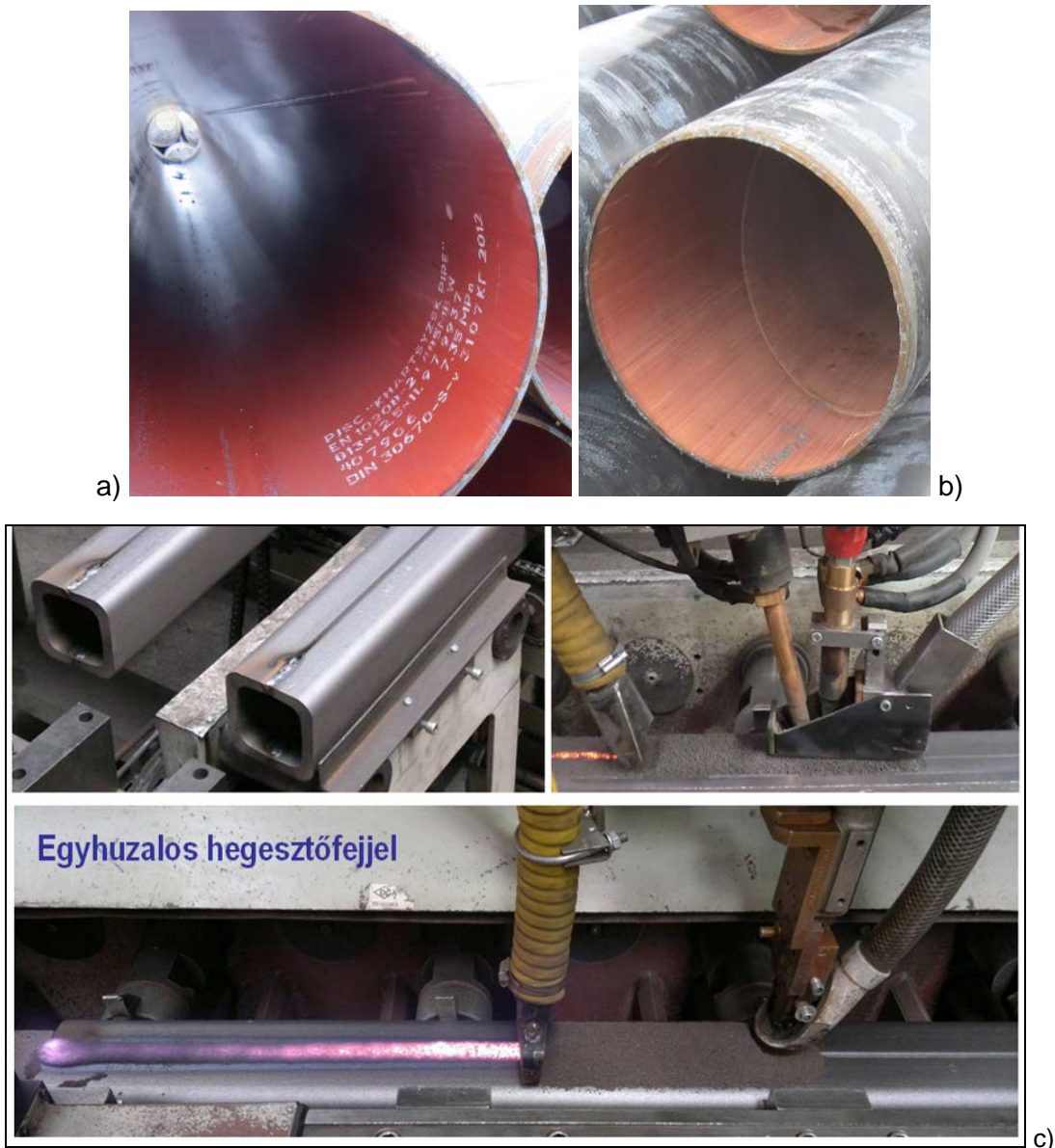
14. ábra. 813×12,5 mm méretű gáztávvezetési csövek gyártása; hosszvarratos cső (a), spirálvarratos cső (b). Tehergépkocsi-futómű csőtengelyének gyártása fedett ívű hegesztéssel (c)
