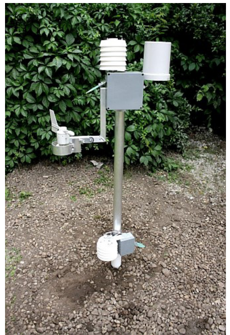
4. ábra. A „szántóföld internete”: az Agrodát projekt keretében telepített meteorológiai adatgyűjtő oszlop Forrás: Agrodát projekt, Élő Gábor hozzájárulásával
