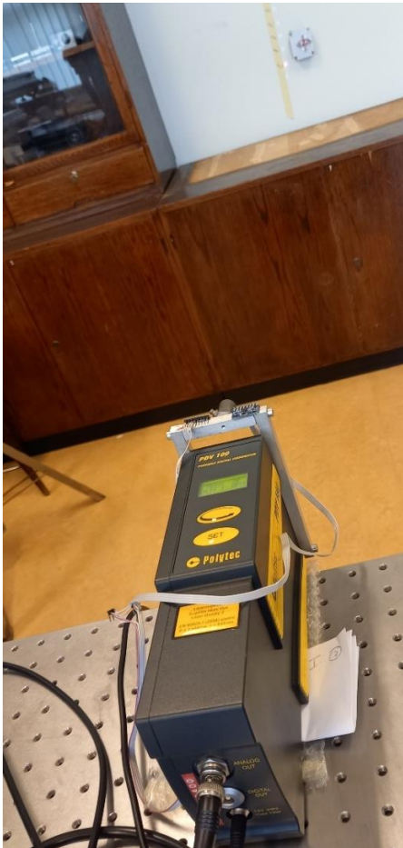
2. ábra. A rezgésmentes asztalon lévő LDV eszköz (balra lent), a LIMA eszköz (jobbra lent), valamint a falra erősített mérőoldali sarokprizma (LIMA) és visszaverő fólia (LDV) működés közben (fent)
