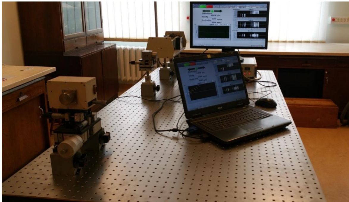
1. ábra. A lézerinterferometrikus mozgásanalizátor az új rezgésmentes asztalon működés közben
