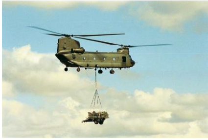
23. sz. kép A hídszállító utánfutó szállítása függesztett teherként 47
