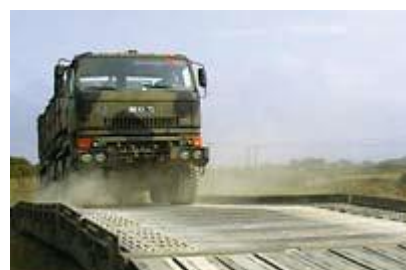
16. sz. kép A híd járófelületének beépítése 41
