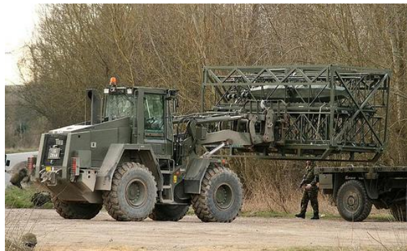
3. sz. kép A hídkészlet lemálházása a szállítójárműről 12
