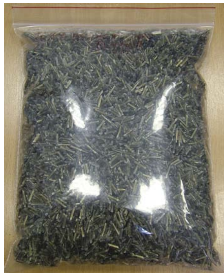
2. ábra. A PLA-val bevont bazaltroving előgyártmány a darabolás után
