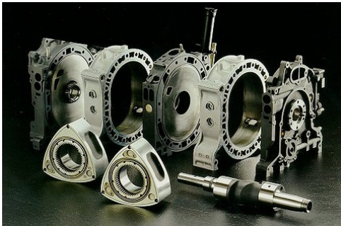
2. ábra. Kétdugattyús Wankel-motor fontosabb alkatrészi (forrás: internet)
