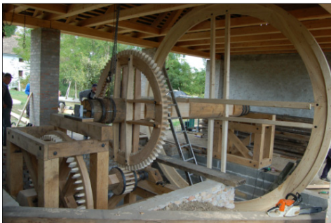
6. ábra. A két gyorsító fogaskerékpár
