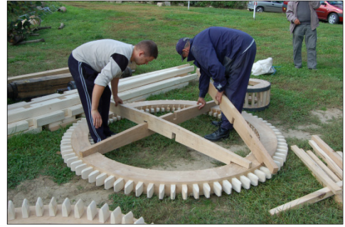
7. ábra. A homlokfogazású, fából készült fogaskerék
