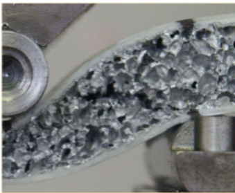
1. ábra. Rögzített rúd kísérlet során bekövetkezett károsodása [5]
