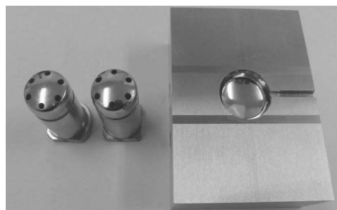
4. ábra. Fröccsöntő szerszám ultraprecíz megmunkálása ultrahangos rezgésekkel [3]
