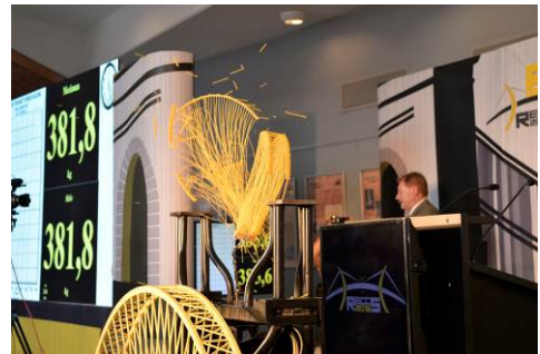
9. ábra. Verseny közben szétrobbanó tartó [1]
