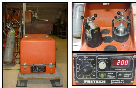
9. ábra. Az őrlésnél használt golyósmalom
