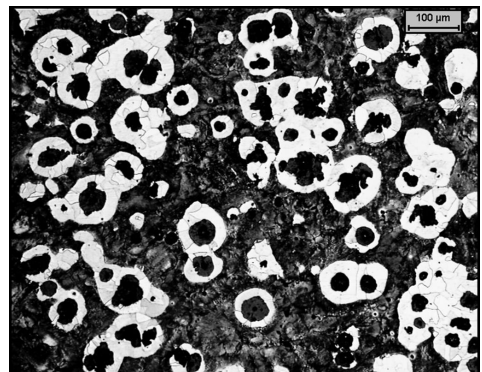
4. ábra. Gömbgrafitos öntöttvas szövetképe hagyományos maratás esetén
