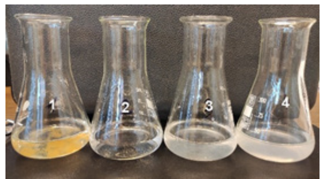
Fig. 3 Coagulation process; 1) 0.3 mL \text{FeCl}_3 ; 2) 0.135 mL PACl; 3) 0.9 mL PACl, 4) 2.1 mL PACl
