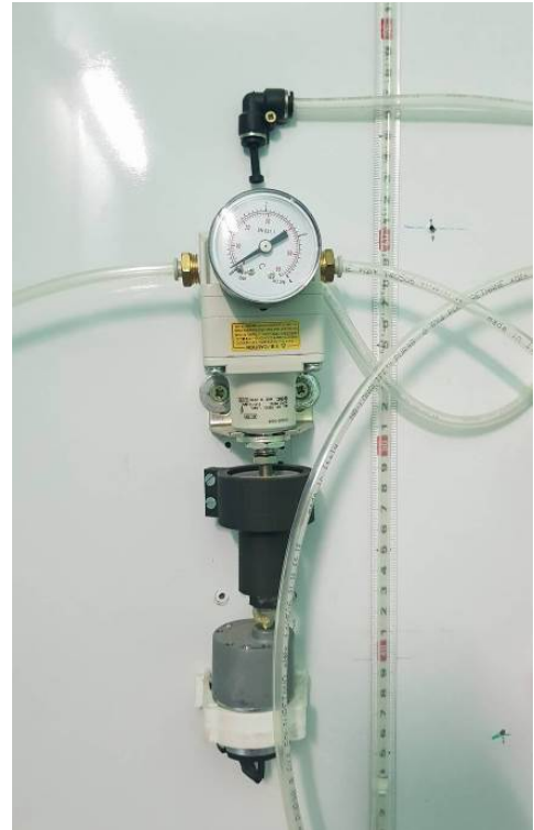
12. ábra. Egy nyomást mérő és vezérlő alegység (a háttérben egy bürettával).
