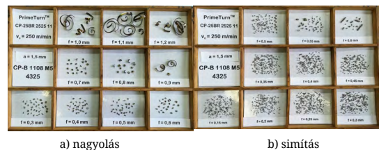
3. ábra. A különböző üzemmódok forgácsablója ( v_c = 250 m/műn; a = 1,5 mm)
