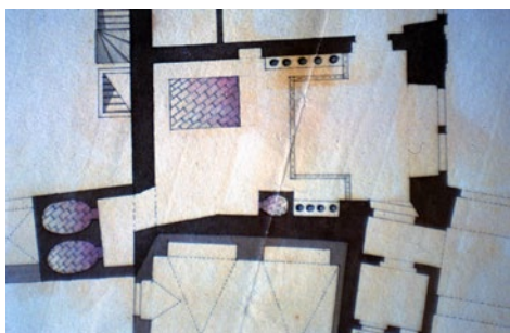
39. Boltozott barokk konyha alaprajza kifelé szolgáló kettős kemencével
