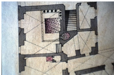
38. Boltozott barokk konyha alaprajza lépcső alá épített kemencével
