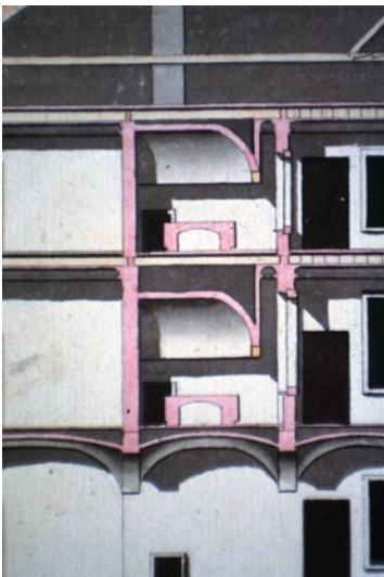
43. Eckermann József tervének konyhametszeten jól látható a tűztér kupola és a tűzpadka szerkezete
