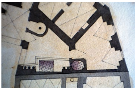
37. Boltozott barokk konyha alaprajza kettős trapéz térben
