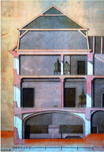
60. Gyula, a kastély 1762-es tervrajzának függőleges metszetén alul a konyha talajszintje négy lépcsőfokkal mélyebben van a többi helyiségnél
