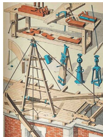
16c. Egyszerű „trispastos” állásos emelőszerkezet a 19. századból. Azonos a középkori emelőszerkezettel (Mazevale 1901)
