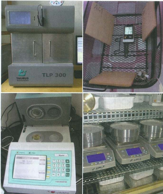
2. ábra: Laboratóriumi vizsgálatok a falazóblokkokat alkotó anyagok épületfizikai tulajdonságainak meghatározásához, hővezetési tényező, nedvességtároló képességek és paradiffúziós egyenértékű szám meghatározása
